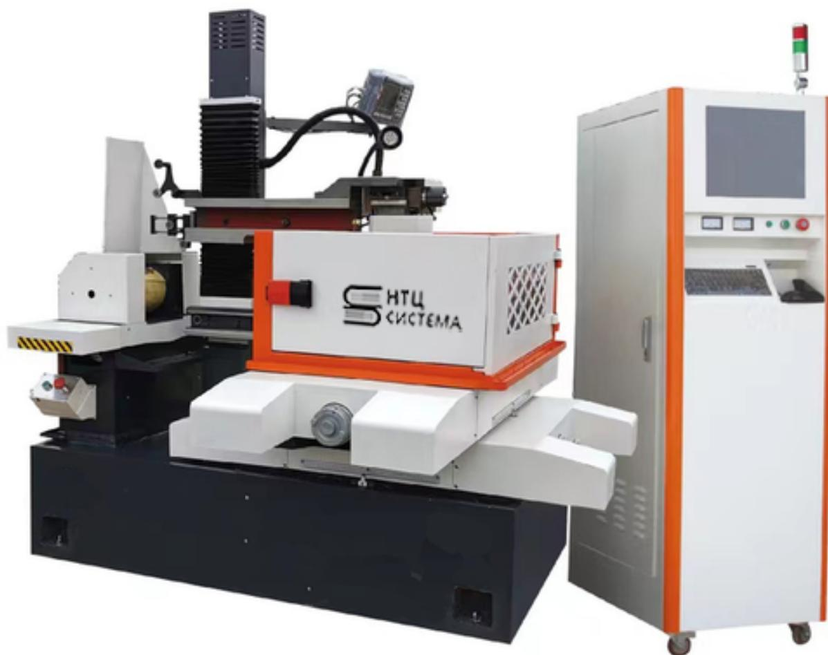
Проволочно-вырезной станок с ЧПУ модели SM7147 является станком многопроходного типа. Станок является полностью автоматическим - генератор переключения режимов обработки происходит автоматически.
